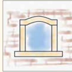
↑ Umrahmung mit gebogenem und seitlich aufliegen- dem Sturz
